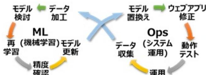
(図) 機械学習モデルの開発からシステム運用までの一連の流れ
