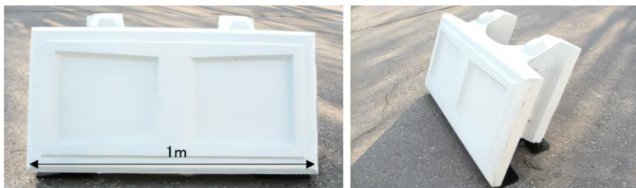
【図 3】アルカリ活性材料コンクリートで製造したプレキャストコンクリート製品の単品外観
