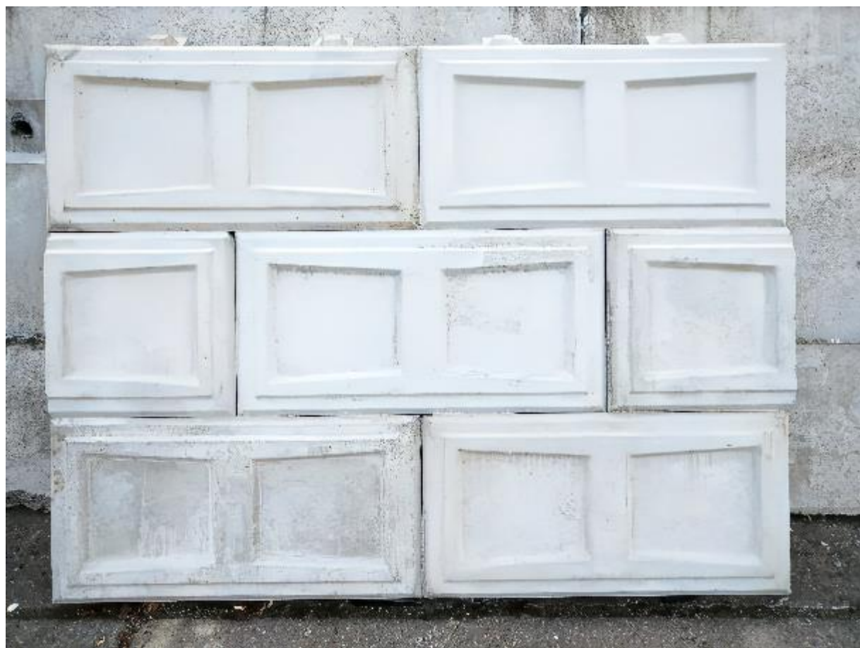
【図 4】アルカリ活性材料コンクリートで製造したプレキャストコンクリート製品の積層外観
