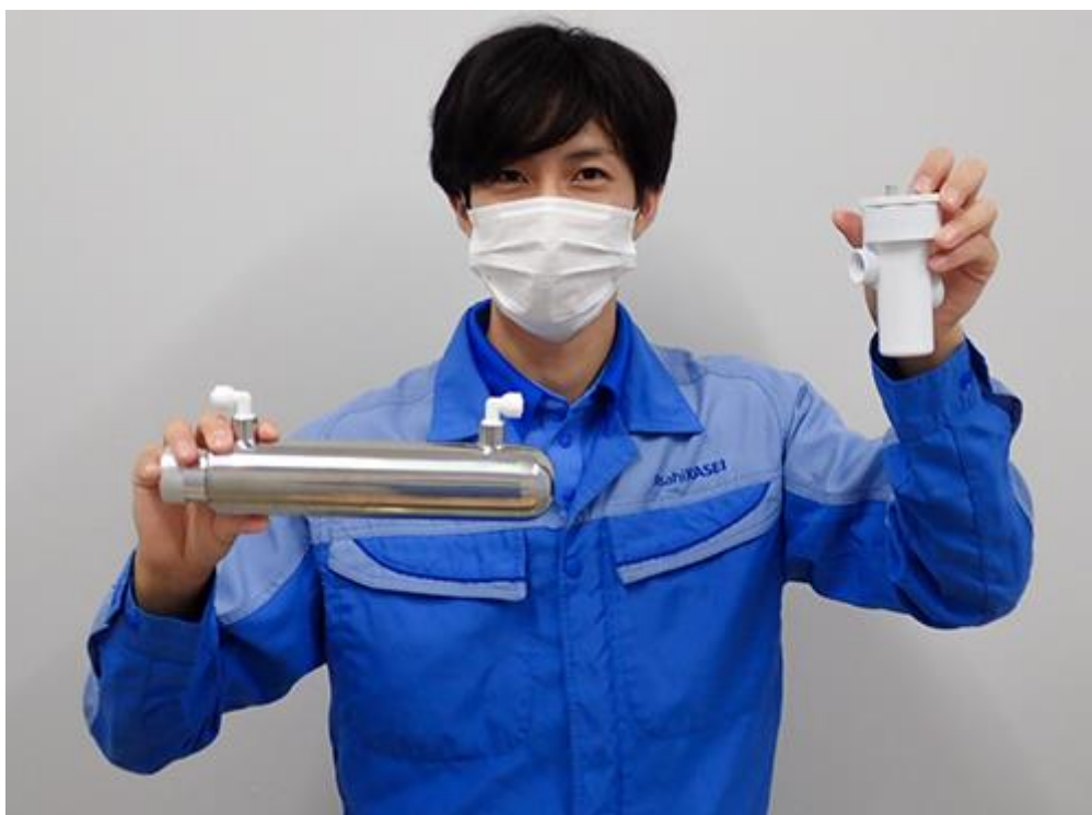
図 2 開発品(右)と市販の水銀灯式流水殺菌器(左)
