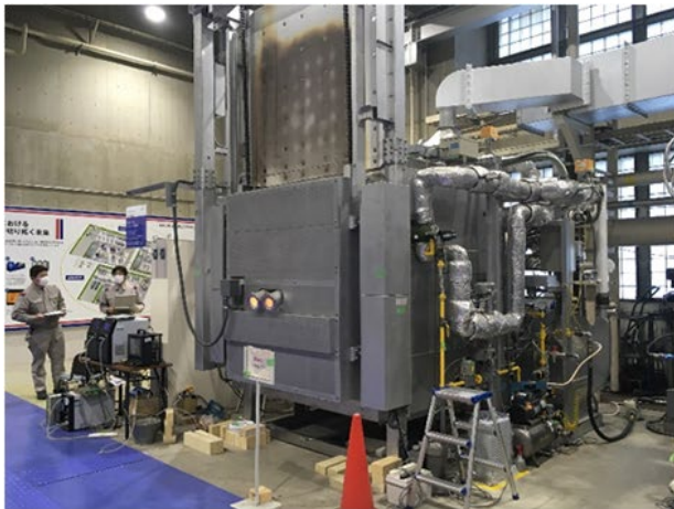
東京ガス試験場におけるセラミック焼成水素燃焼試験の様子
