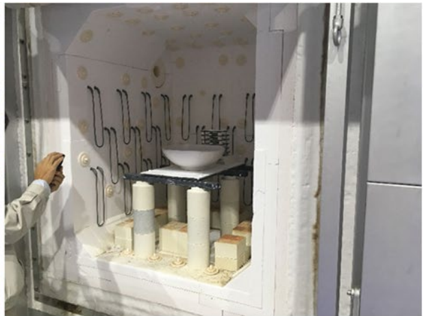
東京ガス試験場におけるセラミック焼成水素燃焼試験の様子
