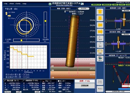
モノパイル打設時の高精度な管理を実現
