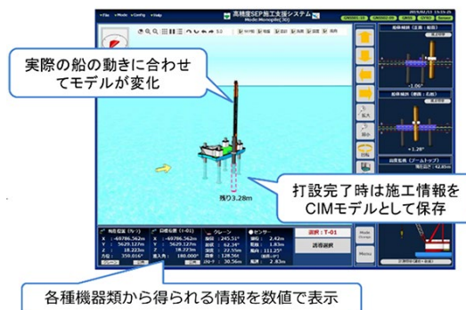
施工状況をクラウド経由で情報共有
