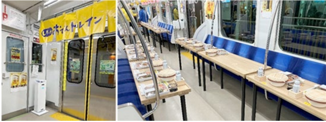
図-3:車両内に設置された空気殺菌装置と車両内の様子
