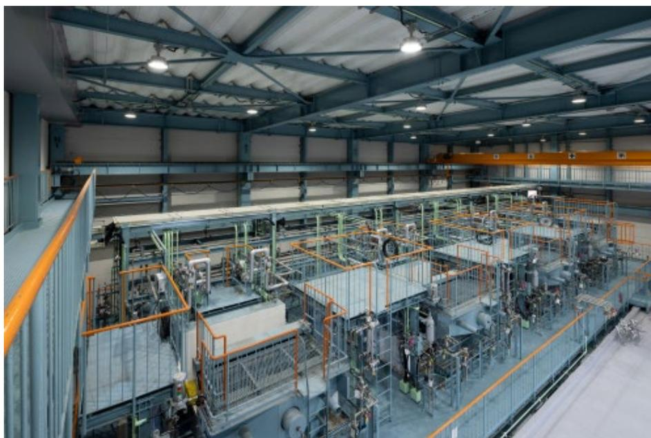
アルカリ水電解パイロット試験設備
