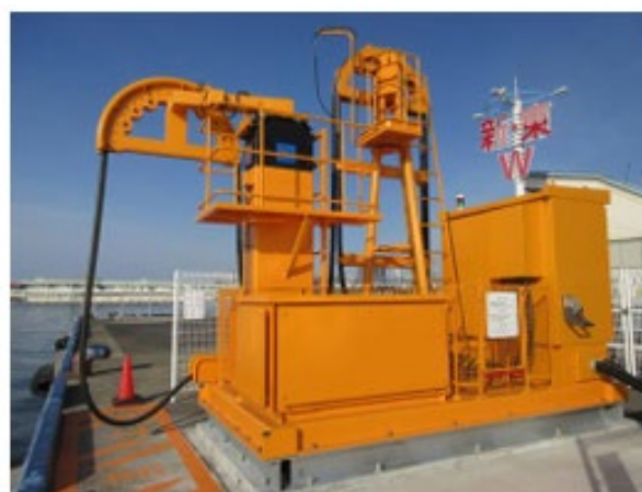
ケーブルマネジメントシステム (神戸市港湾局様向け)
