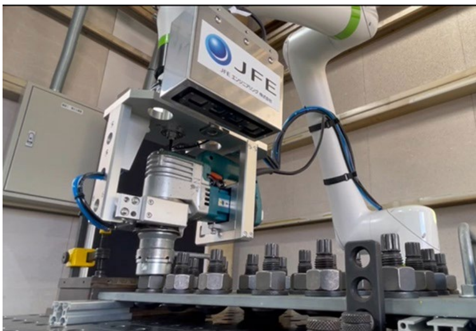
協働ロボットを用いたボルト締め付け実証試験の様子
