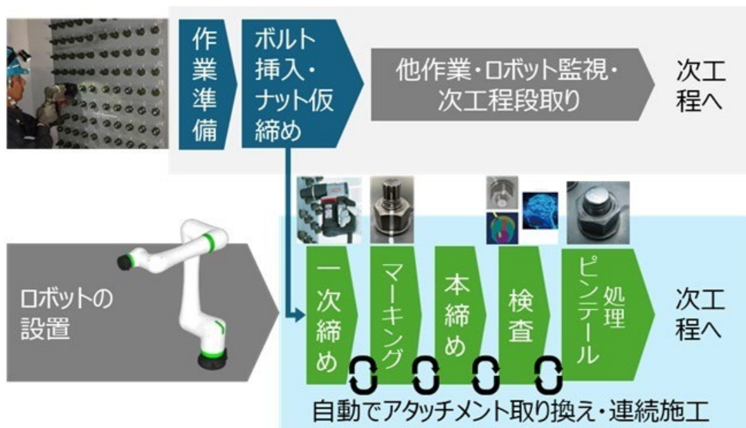
協働ロボットを用いたトルシア型高力ボルトの締め付けワークフロー
